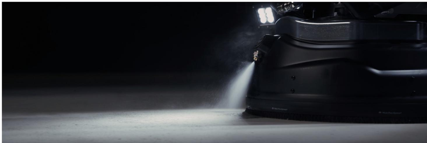
Запатентованная система MCS™ (система охлаждения тумана) увеличивает эффективность шлифования и скорость резания до 100%. Уникальная система состоит среди других деталей насоса и форсунки. Форсунка распыляет на бетонную поверхность мелкодисперсный водяной туман. Это охлаждает алмазный инструмент, и становится легче шлифовать твердый бетон и избегать «остекления».
